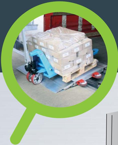
Das einzigartige, zweifach bewegliche Auffahrprofil gleicht Unebenheiten an Rampen perfekt aus. So können Lasten bis 5.000 kg reibungslos verladen werden.
