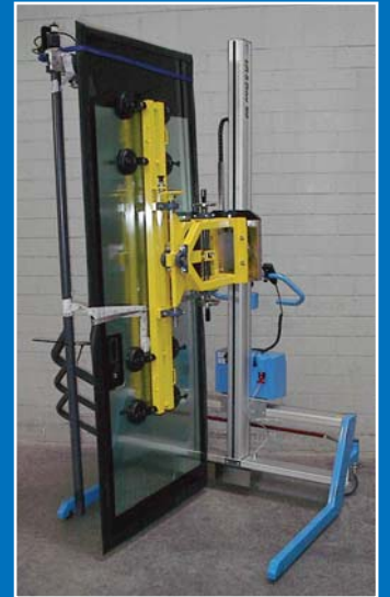
Fahrzeigtürenhandierung in Montage- und Servicebereichen
