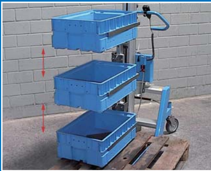
Abstapelhilfe zur Sicht- und Qualitätskontrolle
