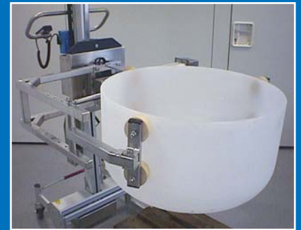
Glastiegelhandlung mit Greif- und Wendevorrichtung
