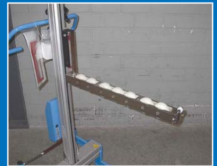
Rollendorn mit integrierter Bremse z.B. für Rollen- und Coilhandlung
